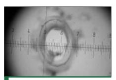
Mesure d'une perforation laser d'environ 65 µm x 75 µm à l'aide d'un microscope équipé d'un micromètre oculaire (au grossissement de 200 : 1 unité = 50 µm)
