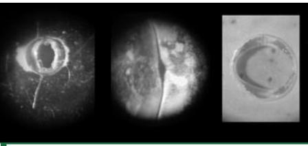
Micro-perforations selon différentes techniques ( à gauche pointe chaude, au centre pointe froide et à droite laser).
