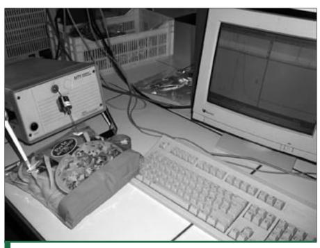
Évaluation de la perméabilité par mesure de l'évolution gazeuse à l'intérieur d'un sachet
